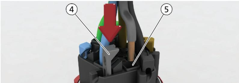
7. Prüfen Sie durch leichtes Ziehen, ob die Einzelleiter fest sitzen. Sollte das nicht der Fall sein, öffnen Sie die Klemme und wiederholen Sie den vorhergehenden Schritt.
