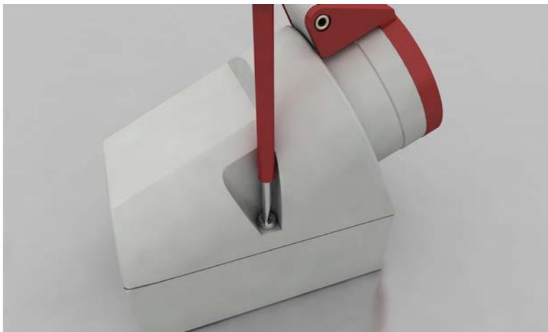
3. Öffnen Sie die Kontaktschieber (5) durch Aufhebeln mit einem Schraubendreher und ziehen Sie die Einzelleiter aus den Klemmen.
