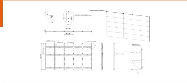
Vogel's hat ein komplettes Set Videowand-Adapter für die Gestaltung einer 5x5 Full HD-Videowand mit den LED-Displays der IFR- und IER-Serien von Samsung zusammengestellt.
