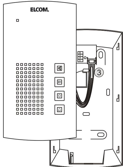
Montieren Sie den Gehäuseboden und schließen Sie die Zuleitung an.
