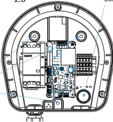
Befestigen Sie die Box mit 3 Schrauben an der Wand. Verwenden Sie je nach Wandmaterial die beiliegenden 6-Kant-Schrauben und Universaldübel.
