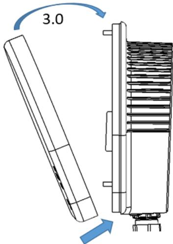
Bringen Sie die Abdeckung wie im Bild gezeigt am horizontalen Rand an und schließen Sie sie vorsichtig. Die korrekte und dichte Befestigung ist wichtig, um sicherzustellen, dass das Gerät ordnungsgemäß abgedichtet ist.
