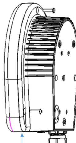
Befestigung der Abdeckung mit 3 Torxschrauben von hinten. Wenden Sie beim Anziehen der Schrauben nicht zu viel Kraft an. Der Deckel muss vollständig und ohne sichtbaren Abstand zur Basis geschlossen sein.
