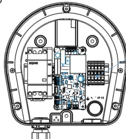
Schließen Sie die Stromquelle gemäß den örtlichen Normen und Gesetzen an die Klemmen an. Stellen Sie sicher, dass die Verbindungen fest und korrekt sind.
