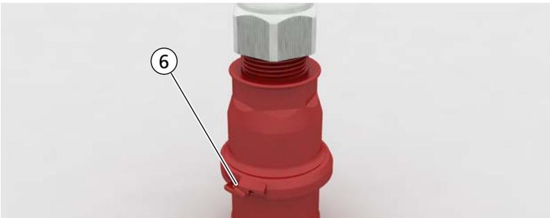
9. Ziehen Sie anschließend die Kabelverschraubung (3) fest an. Das Anzugsdrehmoment muss dabei für die 16-A-Ausführungen zwischen 4 Nm und 7 Nm liegen, für die 32-A-Ausführungen zwischen 5 Nm und 9 Nm. Entnehmen Sie den genauen Wert je nach Ausführung der Prägung auf der Kabelverschraubung. Sichern Sie die Kabelverschraubung durch die dafür vorgesehene seitlich angebrachte Schraube (8, je nach Ausführung).
