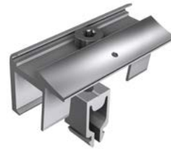
Endklemmen mit Erdungspin für Rahmenhöhe 28 mm – 45 mm
