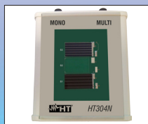
HT304N Duo Referenz- zelle für Einstrahlungs- messung
