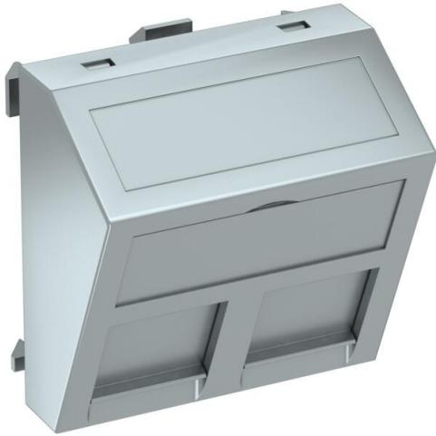
Datentechnikträger mit schrägem Auslass und Verschlussziehschraube zur Aufnahme von zwei Datentechnik-Anschlussmodulen mit RJ45-Buchse. Die Rastbefestigung eignet sich für den waagerechten und senkrechten Einbau in die Systemumgebung. Typ C hat eine Montageöffnung von 19,30 X 14,80 mm und ist für die direkte Befestigung der Daten-Anschlussmodule in der Montageöffnung ausgelegt.
