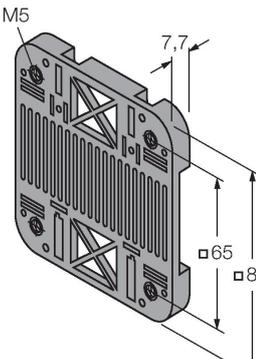
Montageplatte für DIN-Hutschiene, geeignet für Bauform CP80, DX80, K80, Q80, Betriebstemperatur: -20...+90 °C
