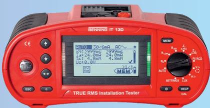
RCD-EV 30/6 mA Auto-Prüfung mit BENNING IT 130 / EV 3-2
