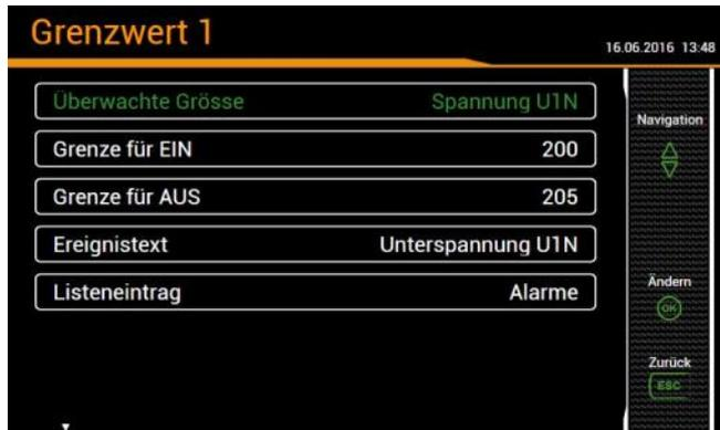
Mit Grenzwerten kann entweder die Überschreitung eines Wertes (oberer Grenzwert) oder die Unterschreitung eines Wertes (unterer Grenzwert) überwacht werden.
