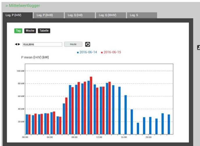
Die anzuzeigende Mittelwertgröße kann über die Auswahl des entsprechenden Registers vorgenommen werden. Es werden drei unterschiedliche Darstellungen unterstützt:
