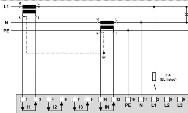
Falls der Strom  $I_N$  nicht gemessen werden soll, kann der entsprechende Wandler weggelassen werden. Falls die Spannung  $U_{NE}$  nicht gemessen werden soll, kann der Anschluss von PE entfallen.
