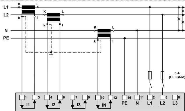
Falls der Strom  $I_N$  nicht gemessen werden soll, kann der entsprechende Wandler weggelassen werden. Falls die Spannung  $U_{NE}$  nicht gemessen werden soll, kann der Anschluss von PE entfallen. Beim AM2000 stehen die Anschlüsse IN und PE nicht zur Verfügung.
