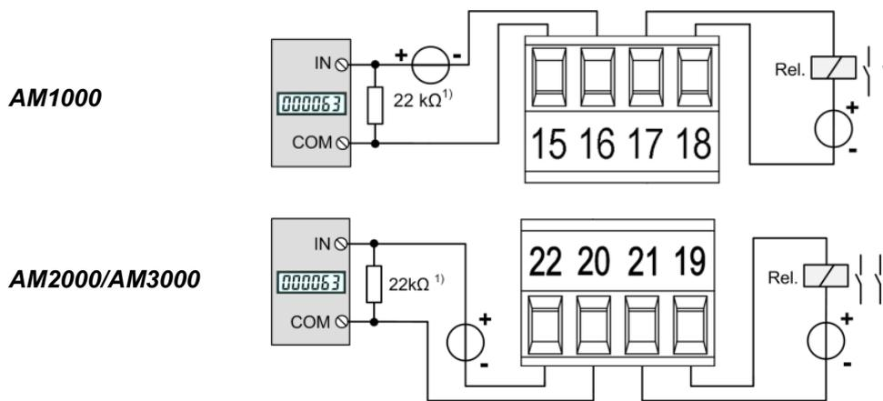
1) Empfohlen falls Eingangsimpedanz des Zählwerks > 100 kΩ
