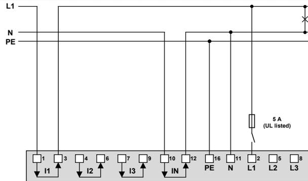
Falls der Strom  $I_N$  oder die Spannung  $U_{NE}$  nicht gemessen werden sollen, kann der Anschluss von IN bzw. PE entfallen.
