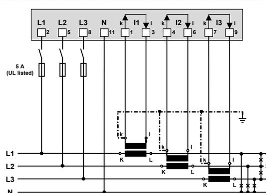
Falls der Strom  $I_N$  nicht gemessen werden soll, kann der entsprechende Wandler weggelassen werden. Falls die Spannung  $U_{NE}$  nicht gemessen werden soll, kann der Anschluss von PE entfallen.
