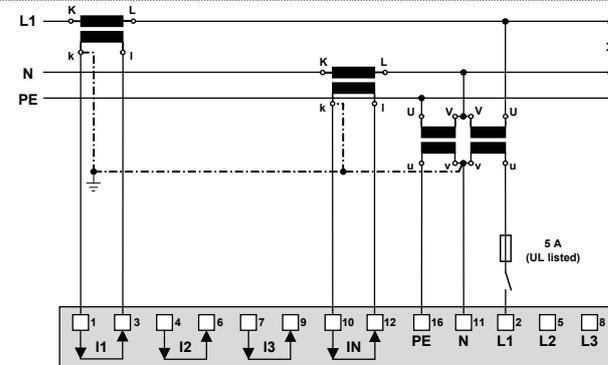
Falls der Strom  $I_N$  oder die Spannung  $U_{NE}$  nicht gemessen werden sollen, können die entsprechenden Wandler weggelassen werden.
