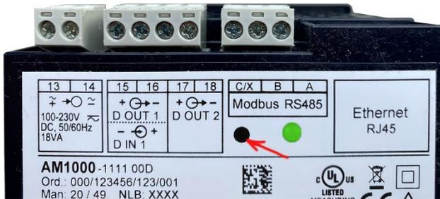
Die versenkte Reset-Taste (links neben der Betriebs-LED) für mindestens 3s drücken. Dazu muss die Folie durchstochen werden. Während dem Reset blinkt die Betriebs-LED rot.
