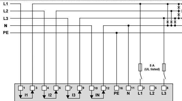
Falls der Strom  $I_N$  oder die Spannung  $U_{NE}$  nicht gemessen werden sollen, kann der Anschluss von IN bzw. PE entfallen.
