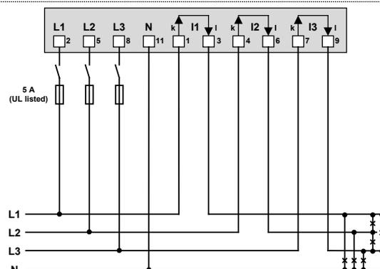
Falls der Strom  $I_N$  oder die Spannung  $U_{NE}$  nicht gemessen werden sollen, kann der Anschluss von IN bzw. PE entfallen.
