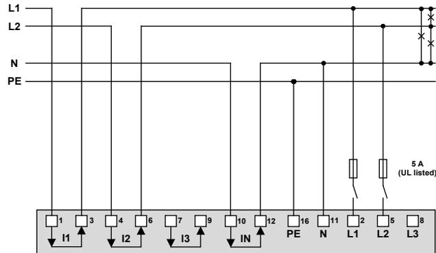
Falls der Strom  $I_N$  oder die Spannung  $U_{NE}$  nicht gemessen werden sollen, kann der Anschluss von IN bzw. PE entfallen. Beim AM2000 stehen die Anschlüsse IN und PE nicht zur Verfügung.
