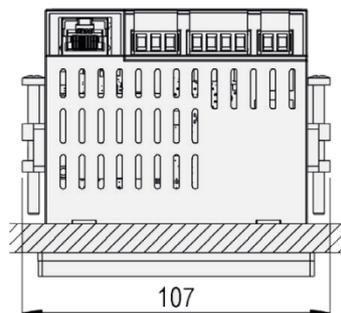
**AM1000 für Hutschiene mit Display: Alle Masse in [mm]**
