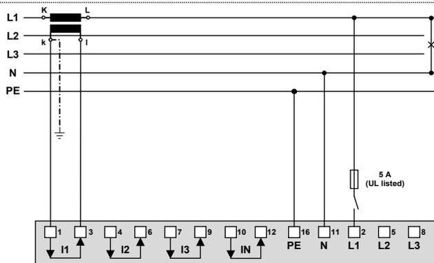
Falls die Spannung  $U_{NE}$  nicht gemessen werden soll, kann der Anschluss von PE entfallen. Beim AM2000 steht PE nicht zur Verfügung.
