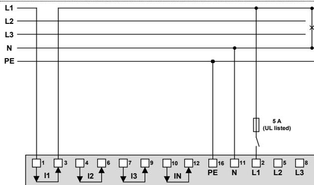
Falls die Spannung  $U_{NE}$  nicht gemessen werden soll, kann der Anschluss von PE entfallen. Beim AM2000 steht PE nicht zur Verfügung.
