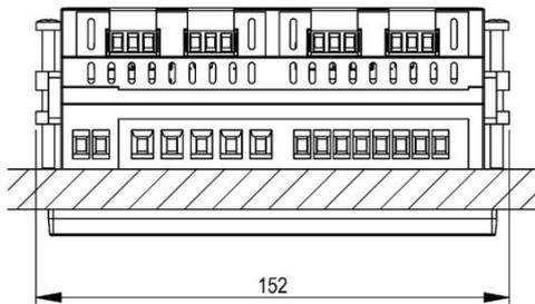
AM1000 mit Display: Alle Masse in [mm]
