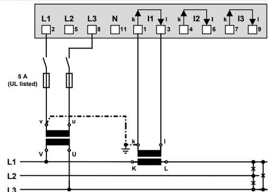
Bei Strommessung über L2 oder L3, Anschluss nach folgender Tabelle vornehmen:
