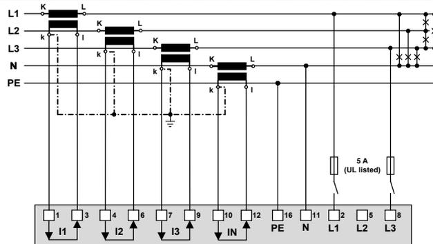
Falls der Strom  $I_N$  nicht gemessen werden soll, kann der entsprechende Wandler weggelassen werden. Falls die Spannung  $U_{NE}$  nicht gemessen werden soll, kann der Anschluss von PE entfallen.
