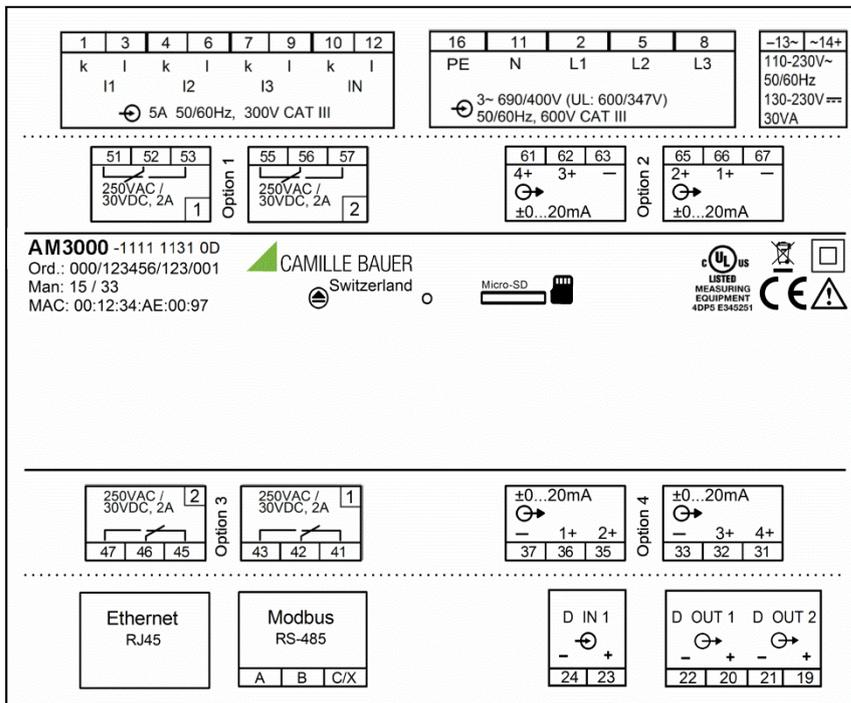
Typenschild eines **AM3000** mit
