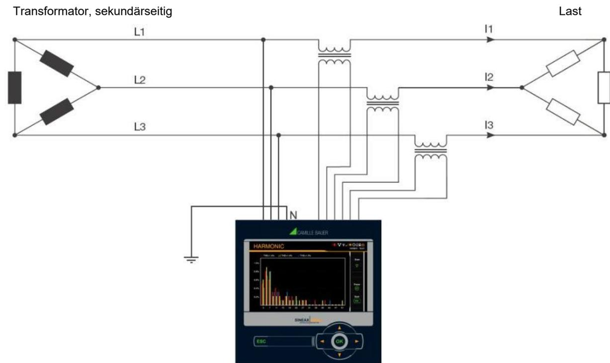
Da sich auch im Fehlerfall das aus den drei Phasen gebildete Spannungsdreieck nicht ändert, werden Spannungs-, Strom- und Leistungswerte des Dreiphasennetzes weiterhin richtig gemessen und angezeigt. Auch die Zähler arbeiten weiterhin bestimmungsgemäss.
