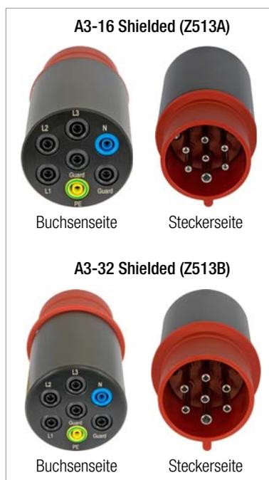
Die Drehstromadapter A3-16 Shielded und A3-32 Shielded dienen dem problemlosen Anschließen von Prüfgeräten an 7-polige CEE-Steckdosen.
