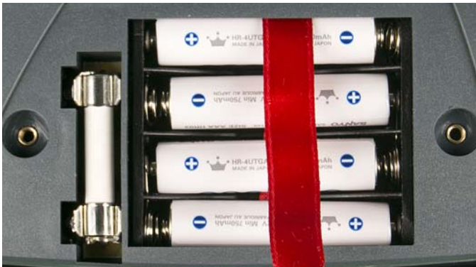
Bild 5 Korrekte Polarität der Zellen
