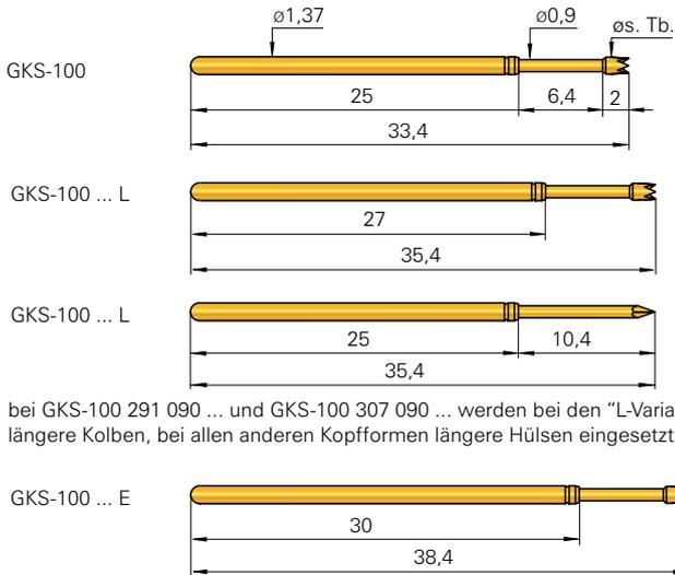
bei GKS-100 291 090 ... und GKS-100 307 090 ... werden bei den "L-Varianten" längere Kolben, bei allen anderen Kopfformen längere Hülsen eingesetzt.
