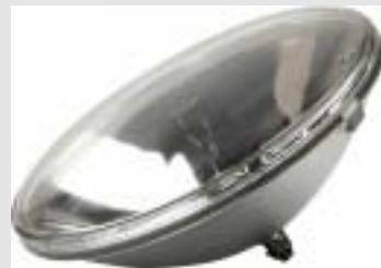
Halogen-Reflektorlampe PAR 64 203x95mm Halogen-Reflektorlampe PAR64, mit Schraubsockel, Abstrahlwinkel 11x7,5°, ANSI-Code Q4559X/SP, für Bühne und Studio. Scharf begrenzter Lichtkegel, Farbfolienschonend, gleichmäßige Wärmeabgabe durch Frontglas, für professionelle Effektbeleuchtung in Diskotheken und auf Bühnen. Dieses Leuchtmittel ist zum Einsatz im Bühnen- und Theaterbereich bestimmt. Dieses Leuchtmittel ist nicht zur Raumbeleuchtung in Haushalten geeignet.
