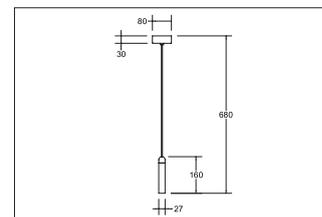
LED-Pendelleuchte, strukturweiß. Pendelmontage, Deckenmontage. Montageart: Pendelmontage, Montageort: Deckenmontage, Material: Aluminium, Schutzart raumseitig: nach DIN EN 60529: IP20, Schutzklasse: (EN 61140) I, Spannung: 230V AC 50Hz, Leistung: 4.2W, Anzahl der Leuchtmittel / Fassungen: 1.0 Stk, Lichtstrom: 220lm, Farbtemperatur: von 3.000 K bis 3.000 K, Lichtfarbe: weiß, Abstrahlwinkel: 38°, Verstellbarkeit: nicht verstellbar, mit Betriebsgerät, Art der Dimmung: schaltbar.
