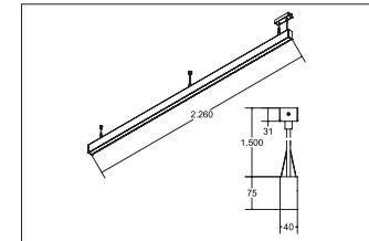
LED-Pendel-Profilleuchte direkt/indirekt BIRO40, silber. Ausführung: LED, Montageart: Pendelmontage, Montageort: Deckenmontage, Material: Aluminium / Acryl, Schutzart: nach DIN EN 60529: IP20, Schutzklasse: (EN 61140) I, Spannung: 230V AC 50Hz, Leistung: 94,9W, Lichtstrom: 10.860lm, Farbtemperatur: 2700 bis 6500K, Lichtfarbe: weiß, Abstrahlwinkel: 80°, Verstellbarkeit: nicht verstellbar, mit Betriebsgerät.
