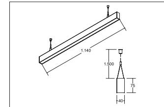
LED-Pendel-Profilleuchte direkt/indirekt BIRO40, schwarz. Ausführung: LED, Montageart: Pendelmontage, Montageort: Deckenmontage, Material: Aluminium / Acryl, Schutzart: nach DIN EN 60529: IP20, Schutzklasse: (EN 61140) I, Spannung: 230V AC 50Hz, Leistung: 45,9W, Lichtstrom: 5.260lm, Farbtemperatur: 2700 bis 6500K, Lichtfarbe: weiß, Abstrahlwinkel: 80°, Verstellbarkeit: nicht verstellbar, mit Betriebsgerät.
