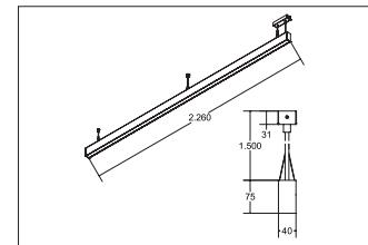
LED-Pendel-Profilleuchte direkt/indirekt BIRO40, silber. Ausführung: LED, Montageart: Pendelmontage, Montageort: Deckenmontage, Material: Aluminium / Acryl, Schutzart: nach DIN EN 60529: IP20, Schutzklasse: (EN 61140) I, Spannung: 230V AC 50Hz, Leistung: 94,9W, Lichtstrom: 11.080lm, Farbtemperatur: 2700 bis 6500K, Lichtfarbe: weiß, Abstrahlwinkel: 80°, Verstellbarkeit: nicht verstellbar, mit Betriebsgerät.
