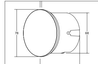
LED-Wandeinbauleuchte für Gerätedosen, weiß, rund. Einbaumontage, Wandmontage. Zur Installation in Hohlwand- oder Betongerätedosen mit einer Einbautiefe von min. 62 mm (Schraubabstand: 60 mm).
