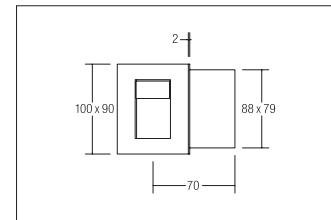
LED-Wandeinbauleuchte, edelstahl. Einbaumontage, Wandmontage. Lieferung inkl. Einputzgehäuse, B: 88 mm, H: 79 mm, ET: 70 mm,
