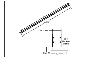
LED-Einbauprofil BIRO40, silber, rechteckig. LED-Lichtkanal mit satinierter Abdeckung. Ausführung: LED, Montageart: Einbaumontage, Montageort: Deckenmontage, Material: Aluminium / Acryl, Schutzart: nach DIN EN 60529: IP20, Schutzklasse: (EN 61140) I, Spannung: 230V AC 50Hz, Leistung: 62,7W, Lichtstrom: 5.470lm, Farbtemperatur: 4000K, Lichtfarbe: weiß, Abstrahlwinkel: 80°, Verstellbarkeit: nicht verstellbar, mit Betriebsgerät, Art der Dimmung: DALI .
