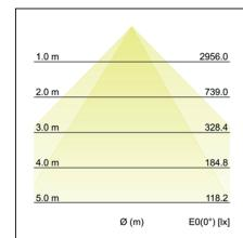
LED-Einbauprofil BIRO40, silber, rechteckig. LED-Lichtkanal mit microprismatischer Abdeckung. Ausführung: LED, Montageart: Einbaumontage, Montageort: Deckenmontage, Material: Aluminium / Acryl, Schutzart: nach DIN EN 60529: IP20, Schutzklasse: (EN 61140) I, Spannung: 230V AC 50Hz, Leistung: 35,8W, Lichtstrom: 3.230lm, Farbtemperatur: 4000K, Lichtfarbe: weiß, Abstrahlwinkel: 80°, Verstellbarkeit: nicht verstellbar, mit Betriebsgerät, Art der Dimmung: DALI .
