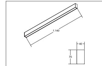
LED-Anbauprofil BIRO40, silber, rechteckig. Ausführung: LED, Montageart: Anbaumontage, Montageort: Deckenmontage, Material: Aluminium / Acryl, Schutzart: nach DIN EN 60529: IP20, Schutzklasse: (EN 61140) I, Spannung: 230V AC 50Hz, Leistung: 31,4W, Lichtstrom: 2.740lm, Farbtemperatur: 4000K, Lichtfarbe: weiß, Abstrahlwinkel: 80°, Verstellbarkeit: nicht verstellbar, mit Betriebsgerät.
