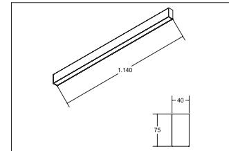
LED-Anbauprofil BIRO40, silber, rechteckig. Ausführung: LED, Montageart: Anbaumontage, Montageort: Deckenmontage, Material: Aluminium / Acryl, Schutzart: nach DIN EN 60529: IP20, Schutzklasse: (EN 61140) I, Spannung: 230V AC 50Hz, Leistung: 31,4W, Lichtstrom: 2.430lm, Farbtemperatur: 3000K, Lichtfarbe: weiß, Abstrahlwinkel: 80°, Verstellbarkeit: nicht verstellbar, mit Betriebsgerät.
