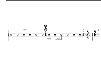
QualityFlex PEFORMANCE, LED-Weißlicht, 4000K, CRI > 95. : 5000.0 mm, Lampenleistung je Meter: 15.0 W/m, Lichtstrom je Meter: 1275.0 lm/m, Schutzart: IP00, Schutzklasse: III, Spannung: 24V DC, Abstrahlwinkel: 120.0 °, 60 LEDs pro Meter, Chip-Abstand (Short Pitch) : 16,66mm. Zur Individuellen Anwendung kann die LED-Flexplatine alle 100 mm eingekürzt werden. Die Maximale Systemlänge von 10.000mm darf mit einer Einspeisung nicht überschritten werden.
