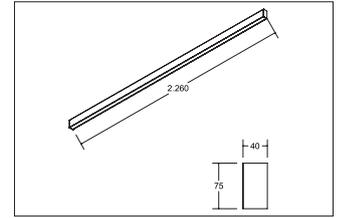
LED-Anbauprofil BIRO40, silber, rechteckig. Ausführung: LED, Montageart: Anbaumontage, Montageort: Deckenmontage, Material: Aluminium / Acryl, Schutzart: nach DIN EN 60529: IP20, Schutzklasse: (EN 61140) I, Spannung: 230V AC 50Hz, Leistung: 62,7W, Lichtstrom: 5.130lm, Farbtemperatur: 2700 bis 6500K, Lichtfarbe: weiß, Abstrahlwinkel: 80°, Verstellbarkeit: nicht verstellbar, mit Betriebsgerät.
