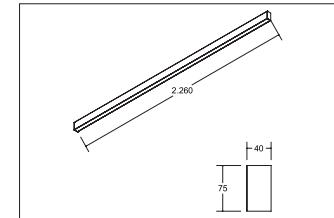
LED-Anbauprofil BIRO40, silber, rechteckig. Ausführung: LED, Montageart: Anbaumontage, Montageort: Deckenmontage, Material: Aluminium / Acryl, Schutzart: nach DIN EN 60529: IP20, Schutzklasse: (EN 61140) I, Spannung: 230V AC 50Hz, Leistung: 62,7W, Lichtstrom: 4.850lm, Farbtemperatur: 3000K, Lichtfarbe: weiß, Abstrahlwinkel: 80°, Verstellbarkeit: nicht verstellbar, mit Betriebsgerät.
