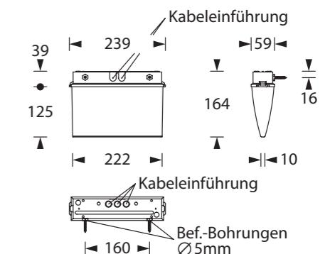
**Deckenmontage / ceiling installation / montage au plafond**
