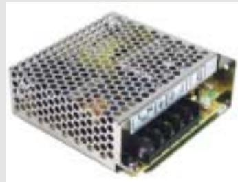
LED-Trafo elektronisch geregelt 99x97x36mm Netzteil/ Transformator zum Betreiben von LED-Band für Architekturbeleuchtung - In:88~264VAC Out:24VDC 10% adj.. Eigenschaften: geschlossene Bauform (case), Schraubanschlüsse, Universaleingang, Überlastschutz durch Abschalten, auto recovery, geschützt gegen Kurzschluss, Überlast, Überspannung, Long Life 105°C Elkos.
