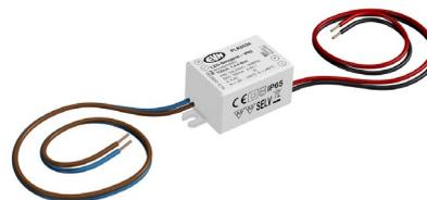
Das LED-Netzgerät lässt sich auf Grund der kleinen Bauform perfekt in Schalterdosen verbauen. Die Anschlussleitungen haben eine Länge von 17cm primärseitig und 17cm sekundärseitig.. Technische Daten: Versorgungsspannung: 100-240V/AC, ta: -20°C - 50°C, tc: 80°C, Powerfaktor 0,40.
