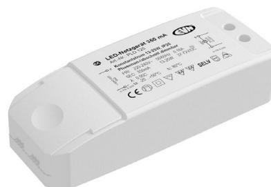
Der kurzschlussfeste Sicherheitstransformator kann problemlos beim Möbelbau zum Einsatz gebracht werden, da die Kennzeichnung MM gegeben ist. Zusätzlich kann das Netzgerät über Phasen- und Phasenabschnitt gedimmt werden. Der Anschluss primärseitig und sekundärseitig erfolgt durch Schraubklemmen, welche für Kabel von 0,75mm<sup>2</sup> - 2,5mm<sup>2</sup> geeignet sind. Technische Daten: Versorgungsspannung: 220-240V/AC, ta: -20°C - 50°C, tc: 80°C, Powerfaktor 0,95.
