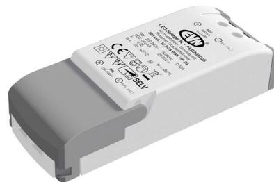
Der kurzschlussfeste Sicherheitstransformator kann problemlos beim Möbelbau zum Einsatz gebracht werden, da die Kennzeichnung MM gegeben ist. Zusätzlich kann das Netzgerät über Phasen- und Phasenabschnitt gedimmt werden. Der Anschluss primärseitig und sekundärseitig erfolgt durch Schraubklemmen, welche für Kabel von 0,75mm<sup>2</sup> - 2,5mm<sup>2</sup> geeignet sind. Technische Daten: Versorgungsspannung: 220-240V/AC, ta: -20°C - 50°C, tc: 80°C, Powerfaktor 0,95.
