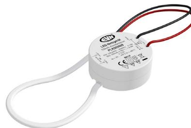
Der kurzschlussfeste Sicherheitstransformator lässt sich auf Grund der kleinen Bauform perfekt in Schalterdosen verbauen, kann aber auch beim Möbelbau zum Einsatz gebracht werden, da die Kennzeichnung MM gegeben ist. Die Anschlussleitungen haben eine Länge von 15cm primärseitig und 16cm sekundärseitig. Technische Daten: Versorgungsspannung: 100-240V/AC, ta: -20°C - 50°C, tc: 80°C, Powerfaktor 0,50.
