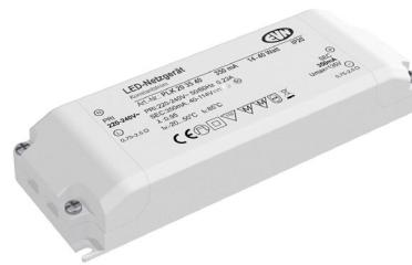
Der kurzschlussfeste Sicherheitstransformator kann problemlos beim Möbelbau zum Einsatz gebracht werden, da die MM-Kennzeichnung gegeben ist. Der Anschluss primärseitig und sekundärseitig erfolgt durch Schraubklemmen, welche für Kabel von 0,75mm<sup>2</sup> - 2,5mm<sup>2</sup> geeignet sind. Technische Daten: Versorgungsspannung: 220-240V/AC, ta: -20°C - 50°C, tc: 85°C, Powerfaktor 0,95.
