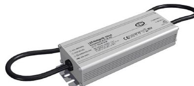
Der kurzschlussfeste Sicherheitstransformator lässt sich auf Grund der höheren Schutzart problemlos im Außenbereich einsetzen, kann aber z. B. auch beim Möbelbau verwendet werden, da die Kennzeichnung MM gegeben ist. Die Anschlussleitungen haben eine Länge von 29cm primärseitig und 29cm sekundärseitig. Technische Daten: Versorgungsspannung: 100-240V/AC, ta: -20°C - 50°C, tc: 80°C, Powerfaktor 0,95.
