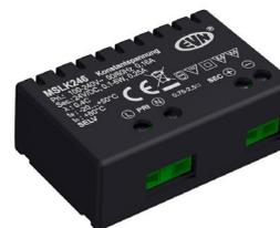
Das LED-Netzgerät lässt sich auf Grund der kleinen Bauform perfekt in Schalterdosen verbauen, kann aber auch beim Möbelbau zum Einsatz gebracht werden, da die Kennzeichnung MM gegeben ist. Der Anschluss primärseitig und sekundärseitig erfolgt durch Schraubklemmen, welche für Kabel von 0,75mm<sup>2</sup> - 2,5mm<sup>2</sup> geeignet sind. Technische Daten: Versorgungsspannung: 100-240V/AC, ta: -20°C - 50°C, tc: 80°C, Powerfaktor: 0,40.
