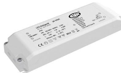
Der kurzschlussfeste Sicherheitstransformator kann problemlos beim Möbelbau zum Einsatz gebracht werden, da die Kennzeichnung MM gegeben ist. Der Anschluss primärseitig und sekundärseitig erfolgt durch Schraubklemmen, welche für Kabel von 0,75mm<sup>2</sup> - 2,5mm<sup>2</sup> geeignet sind. Technische Daten: Versorgungsspannung: 100-240V/AC, ta: -20°C - 50°C, tc: 80°C, Powerfaktor: 0,95.
