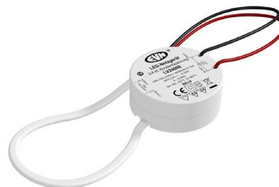
Der kurzschlussfeste Sicherheitstransformator lässt sich auf Grund der kleinen Bauform perfekt in Schalterdosen verbauen, kann aber auch beim Möbelbau zum Einsatz gebracht werden, da die Kennzeichnung MM gegeben ist. Die Anschlussleitungen haben eine Länge von 14cm primärseitig und 17cm sekundärseitig. Technische Daten: Versorgungsspannung: 100-240V/AC, ta: -20°C - 50°C, tc: 80°C, Powerfaktor: 0,90.
