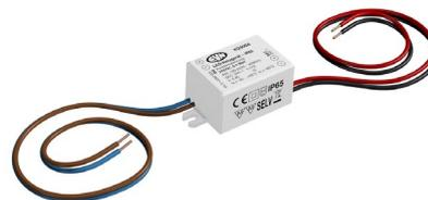
Das LED-Netzgerät lässt sich auf Grund der kleinen Bauform perfekt in Schalterdosen, oder aber auch bei schwierigen Platzverhältnissen verbauen. Die Anschlussleitungen haben eine Länge von 17cm primärseitig und 17cm sekundärseitig. Technische Daten: Versorgungsspannung: 100-240V/AC, ta: -20°C - 50°C, tc: 80°C, Powerfaktor 0,40.
