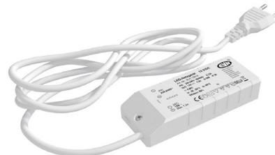
Der kurzschlussfeste Sicherheitstransformator kann problemlos beim Möbelbau zum Einsatz gebracht werden, da die Kennzeichnung MM gegeben ist. Der Anschluss primärseitig und sekundärseitig erfolgt durch Schraubklemmen, welche für Kabel von 0,75mm<sup>2</sup> - 2,5mm<sup>2</sup> geeignet sind, wobei das Netzgerät primärseitig bereits mit einer 1,5m langen Eurozuleitung ausgestattet ist. Technische Daten: Versorgungsspannung: 220-240V/AC, ta: -20°C - 50°C, tc: 85°C, Powerfaktor: 0,80.
