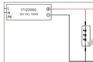
LED-Netzgerät 12 V DC, schaltbar. Dieser Konverter ist durch Sicherungseinrichtungen gegen Überspannung und Kurzschluss sowie thermische und elektrische Überlastung geschützt. Fassung: ohne, Material: Aluminium, Schutzart: nach DIN EN 60529: IP65, Schutzklasse: (EN 61140) I, Spannung: 12V, Leistung: 60–120W, Art der Dimmung: schaltbar, .
