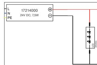
LED-Netzgerät 24 V DC, schaltbar. Dieser Konverter ist durch Sicherungseinrichtungen gegen Überspannung und Kurzschluss sowie thermische und elektrische Überlastung geschützt. Die Eingangs- und die Ausgangsklemme ist für Leitungen mit einem Querschnitt von bis zu 1,5 mm<sup>2</sup> geeignet. Fassung: ohne, Material: Kunststoff, Schutzart: nach DIN EN 60529: IP20, Schutzklasse: (EN 61140) II, Spannung: 24V, Leistung: 1-7,2W, Art der Dimmung: schaltbar, .
