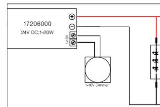
LED-Netzgerät 24 V DC, 1-10 V dimmbar (analog). Dieses Betriebsgerät erfüllt die Anforderungen für Sicherheitsbeleuchtungsanlagen nach DIN EN 50172 VDE 0108-100:2005-01. Dieser Konverter ist durch Sicherungseinrichtungen gegen Überspannung und Kurzschluss sowie thermische und elektrische Überlastung geschützt. Fassung: ohne, Material: Kunststoff, Schutzart: nach DIN EN 60529: IP20, Schutzklasse: (EN 61140) II, Spannung: 24V, Leistung: 1-20W, Art der Dimmung: 1-10 V, .
