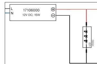
LED-Netzgerät 12 V DC, schaltbar. Dieser Konverter ist durch Sicherungseinrichtungen gegen Überspannung und Kurzschluss sowie thermische und elektrische Überlastung geschützt. Fassung: ohne, Material: Kunststoff, Schutzart: nach DIN EN 60529: IP20, Schutzklasse: (EN 61140) II, Spannung: 12V, Leistung: 1–15W, Art der Dimmung: schaltbar, .
