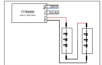
LED-Konverter 700 mA, DALI dimmbar, (digital). Dieser Konverter ist durch Sicherungseinrichtungen gegen Überspannung und Kurzschluss sowie thermische und elektrische Überlastung geschützt. Die Eingangs- und die Ausgangsklemme ist für Leitungen mit einem Querschnitt von 0,75-1,5 mm<sup>2</sup> geeignet. Material: Kunststoff, Schutzart: nach DIN EN 60529: IP20, Schutzklasse: (EN 61140) II, Strom: 700 mA, Spannung: 230V AC 50Hz , Leistung: 2,1-20W, Art der Dimmung: DALI, .
