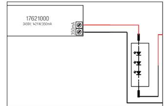
LED-Konverter 350 mA, schaltbar. Dieser Konverter ist durch Sicherungseinrichtungen gegen Überspannung und Kurzschluss sowie thermische und elektrische Überlastung geschützt. Die Eingangs- und die Ausgangsklemme ist für Leitungen mit einem Querschnitt von bis zu 1,5 mm<sup>2</sup> geeignet. Material: Kunststoff, Schutzart: nach DIN EN 60529: IP20, Schutzklasse: (EN 61140) II, Strom: 350 mA, Spannung: 230V AC 50Hz, Leistung: 1-21W, Art der Dimmung: schaltbar, .
