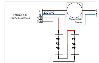
LED-Konverter 350 mA, Phasenabschnitt dimmbar. Dieser Konverter ist durch Sicherungseinrichtungen gegen Überspannung und Kurzschluss sowie thermische und elektrische Überlastung geschützt. Die Eingangs- und die Ausgangsklemme ist für Leitungen mit einem Querschnitt von bis zu 2,5 mm<sup>2</sup> geeignet. Material: Kunststoff, Schutzart: nach DIN EN 60529: IP20, Schutzklasse: (EN 61140) II, Strom: 350 mA, Spannung: 230V AC 50Hz, Leistung: 4,2-10W, Art der Dimmung: Phasenabschnitt, .
